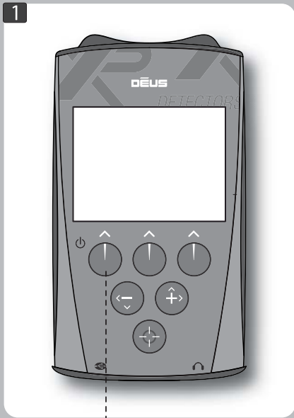
1 Включение на блоке управления (держите катушку подальше от земли и любых металлов)
